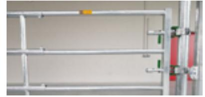
Aufgebaut mit  $\varnothing$  60 mm Rohr. Einsteckteil  $\varnothing$  49 mm. Zwischenstrebe  $\varnothing$  49 mm, 4 Stellschrauben, verstärkte Augenschraube  $\varnothing$  22 mm mit 3 Muttern in einer eingeschweißten Hülse. Höhe durch Umdrehen verstellbar.
