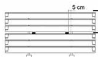
Max. 5 cm zwischen den Zinken des Hebeegerätes und den Hölzern. Mit Gabeln max. 1 Stapel zugleich heben.
